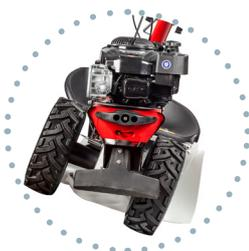
Le kit pour moteur basculant permet, grâce à l'utilisation d'un ballast, d'ajouter une rotation de 25° au moteur permettant une utilisation efficace sur les terrains à forte pente.
