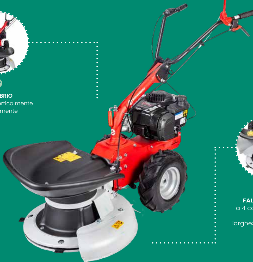
LEVERAGGI trazione + innesto attrezzo con sistema di sicurezza integrato
