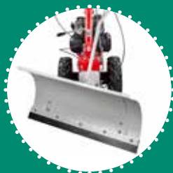
LAME NEIGE 85 cm orientable \pm 30^\circ
