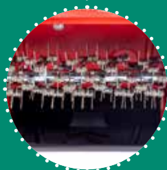
ROTOR avec 56 ressorts INOX
