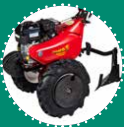
KIT DE LABOUR CLASSIC roues 5.00-10" + axes fixes 2 ballasts roues 20 kg chacun ballast frontal 15 kg charrue classique
