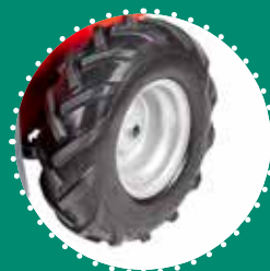
ROUES MOTRICES anti-crevaison 13x5.00-6"
