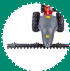
MOUVEMENT BI-LAME deux lames oscillantes coupe 137 cm
