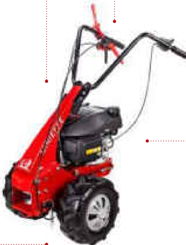
Leva innesto attrezzo leva a pressione con sistema di sicurezza integrato
