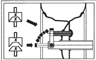
Etichetta schema bloccaggio/sbloccaggio ruote.
