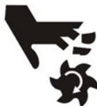
**ATTENZIONE - fresa rotante, non avvicinare le mani alla fresa. | CAUTION - rotating blade, do not put your hands close to the blade. | ACHTUNG - bei sich drehender Fräse nicht mit den Händen in das Hackwerkzeug fassen! Gefahr von Schnittverletzungen! | ATTENTION - fraise tournante, n'approchez pas les mains près de la fraise. | ATENȚIE - freză rotativă, nu apropiați mâinile de freză. | UWAGA - noże obrotowe, nie zbliżać dłoni do noży. |**
