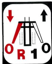
**Im Symbol links : Der rote Hebel (links am Lenkholm) betätigt den Rückwärtsgang.**
